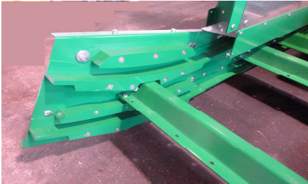
wymienne, połączone śrubami prowadnice łańcuchowe
