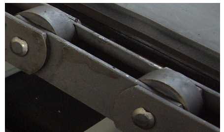
opcjonalne łańcuchy o wytrzymałości do 140 kN na jedną część łańcucha
