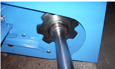
bardzo szerokie koła łańcuchowe, zapewniające płynną pracę maszyny
