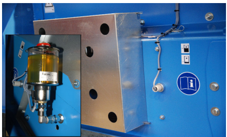
smarownic z zaworem magnetycznym (automatyczne smarowanie łańcucha)
