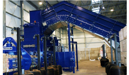
poszerzone ściany boczne w sekcji horyzontalnej i wznoszącej; "szyja łabędzia" mocno opadająca
